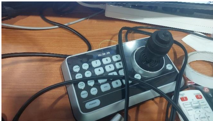
ภาพที่ 4.11 อุปกรณ์ควบคุมห้องกล้องวงจรปิดภายในห้องประชุม
