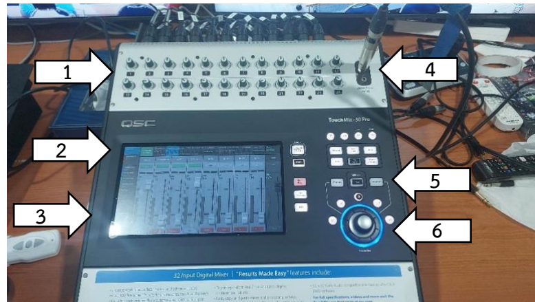
ภาพที่ 4.8 อุปกรณ์ควบคุมเสียง QSC (Mixer Audio)
